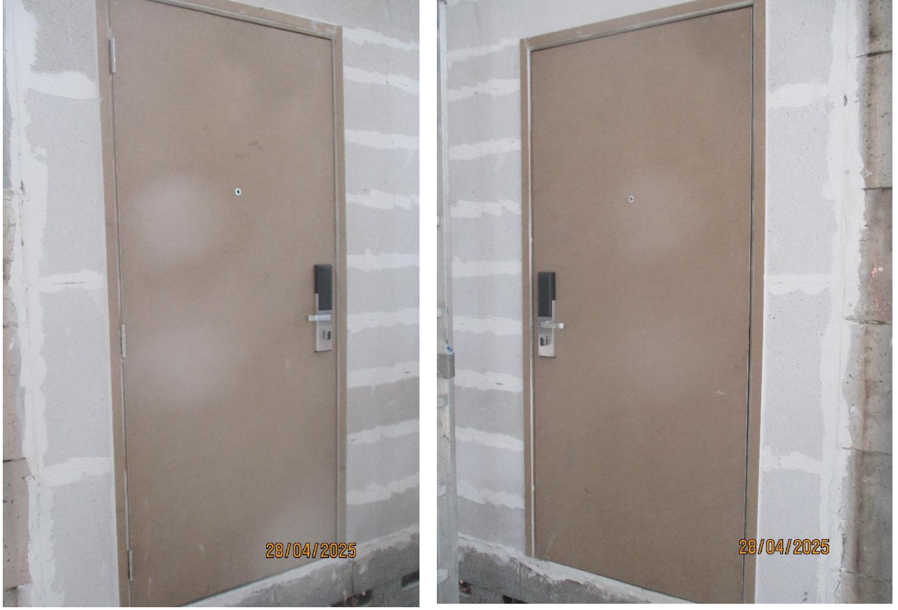
Fotoğraf C2: Her iki kapının aleve maruz kalan yüzeyinin test öncesi görünümü
